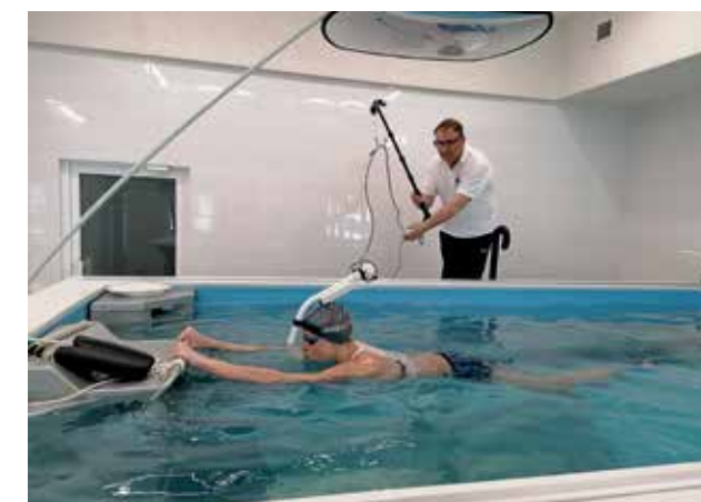
Рис. 9. Тестирование с газоанализом в гидроканале
